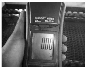
沈澱池の改善状況 (出口濁度0.00度を確保) (前回までは最良で5度)
