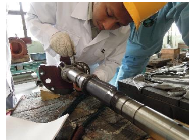
ポンプシャフトの測定
