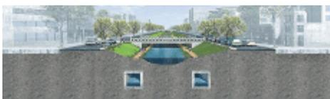
※10 遮集管とは、晴天時に下水及び一定量の雨天時下水を下水処理場へ送水するための管渠。
