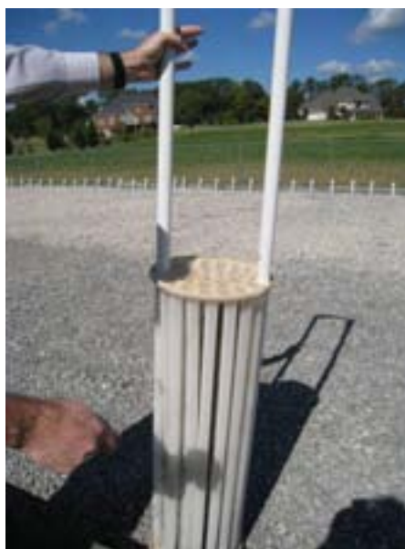
砂利の下に埋められている処理フィルター
