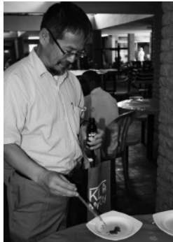
皿に試薬を付け、洗浄度を検査
