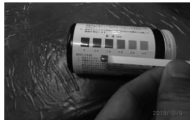
使用後の油を試験紙で検査
