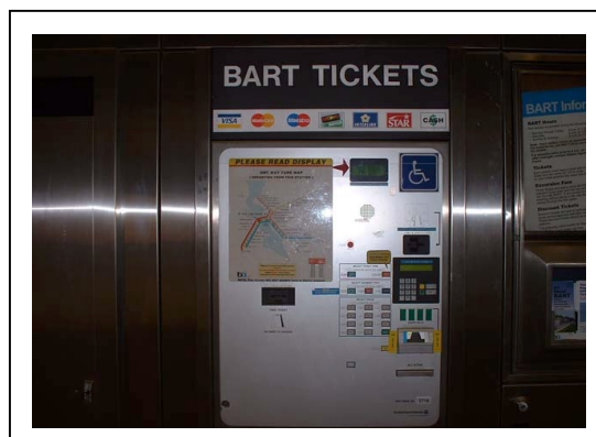
障害者対応切符自動販売機は点字・音声案内機能を備え、車いすからも届くよう低く設置してある。
